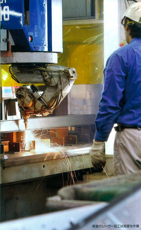
板金のレーザー加工は高度な作業
