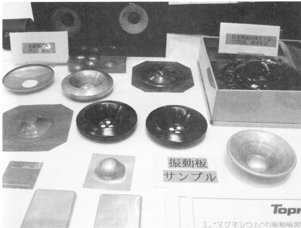
写真4 純マグネシウム振動板の 冷間成形例。防錆対策に 漆を活用(東プレ)
