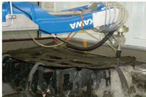
超高压水によるCFRTP加工(ワーク板厚 0.8mm)
