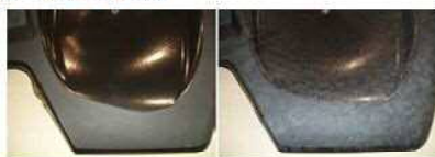
電磁誘導加熱による成形改善事例
