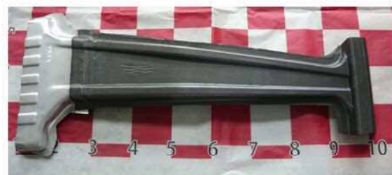
金属+CFRTPの一体成形品 センターピラーサンプル
