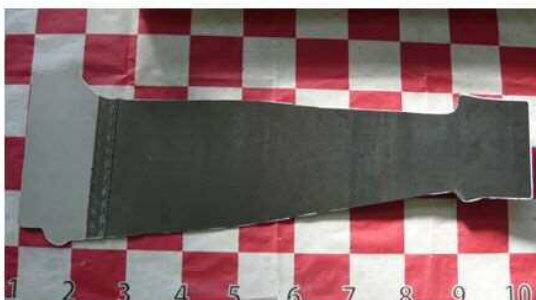
金属+CFRTPの一体成形 スタンパブルシート
